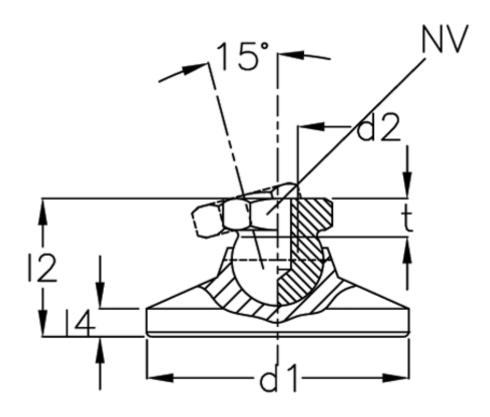
d1 = 25 d2 = 8 l2 = 19 l4 = 4 NV = 12 Static load (kN) = 14 t min = 9
